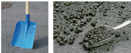
Die typische Probenahmeschaufel ist gekennzeichnet durch deren hochgezogenen seitlichen Ränder.
